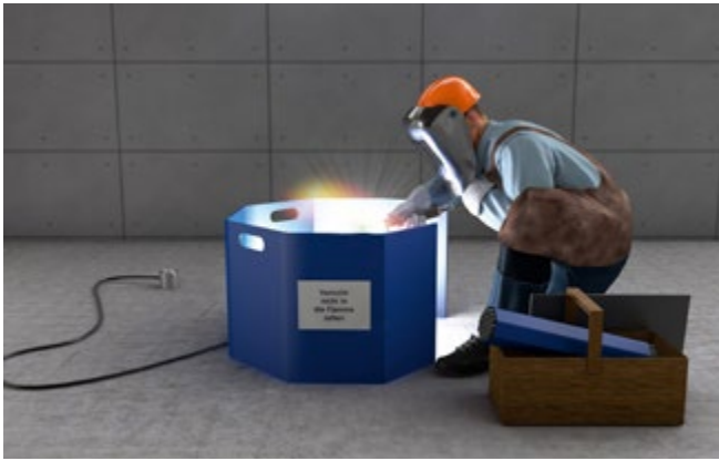
Abb. 85 Schutz weiterer Personen durch Abschirmung beim Lichtbogenschweißen
