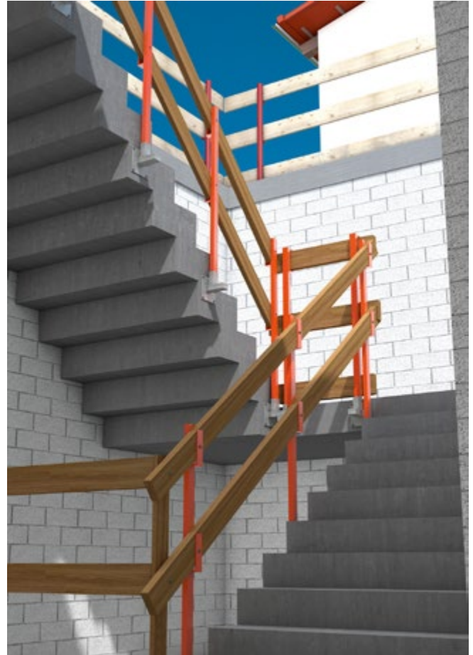
Abb. 132 Treppenaufgang mit Seitenschutz
