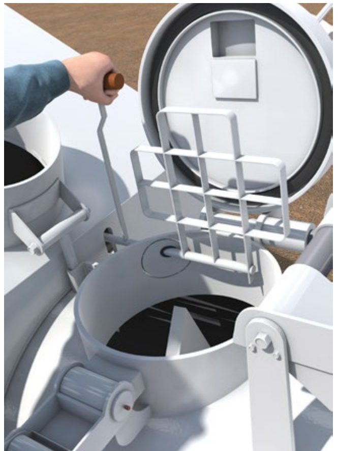
Abb. 103 Einwurf mit Schutzgitter an Estrichmaschine
