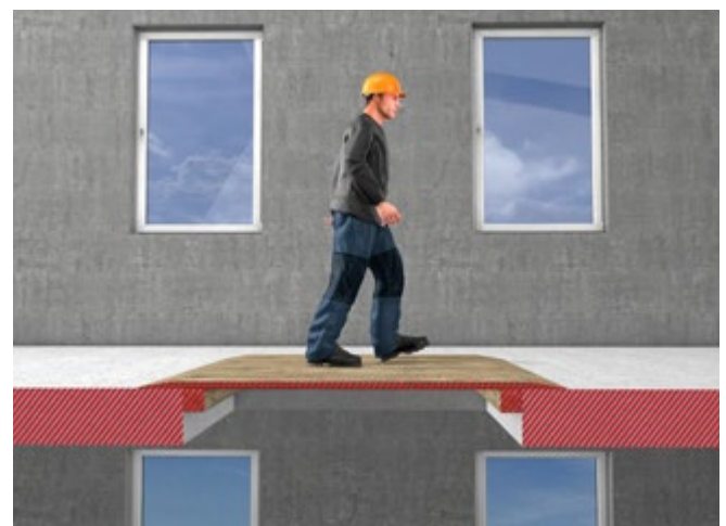
Abb. 8 Darstellung einer Bodenabdeckung im Schnitt
