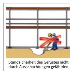
Abb. 59 Warnhinweise zum Gerüst
