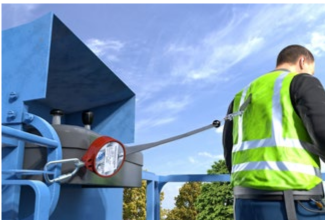
Abb. 65 Einsatz eines Höhensicherungsgerätes im Arbeitskorb
