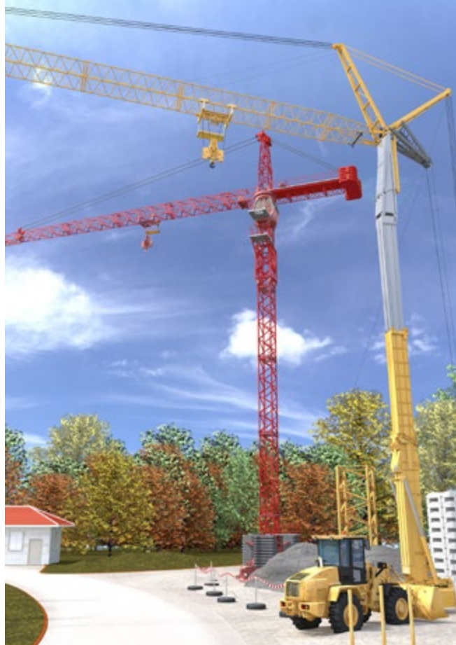
Abb. 71 Stationärer und mobiler Kran
