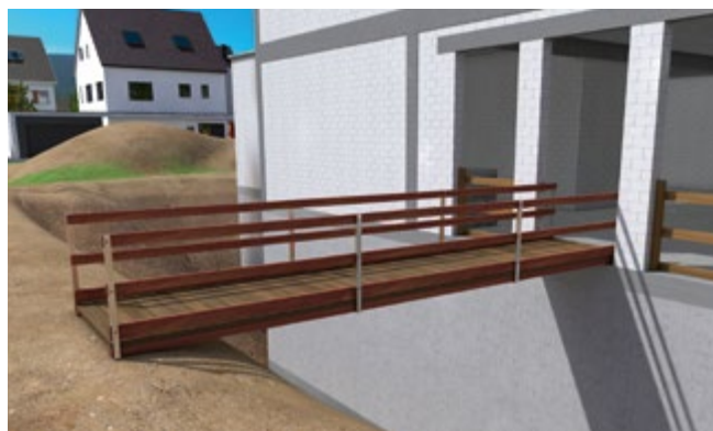
Abb. 8 Laufsteg mit Seitenschutz als Verkehrsweg
