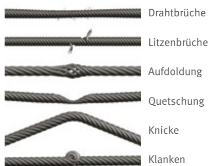
Abb. 91 Beispiele für Ablegekriterien von Drahtseilen
