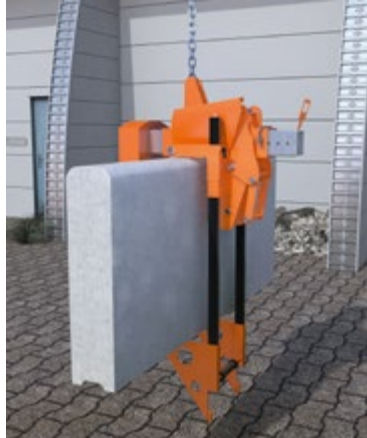
Abb. 112 Lastaufnahmemittel mit Sicherungsbügel für großformatige Teile
