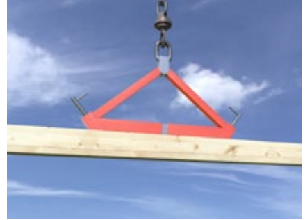
Abb. 132 Beispiel für ein geeignetes Lastaufnahmemittel für Holzbauteile
