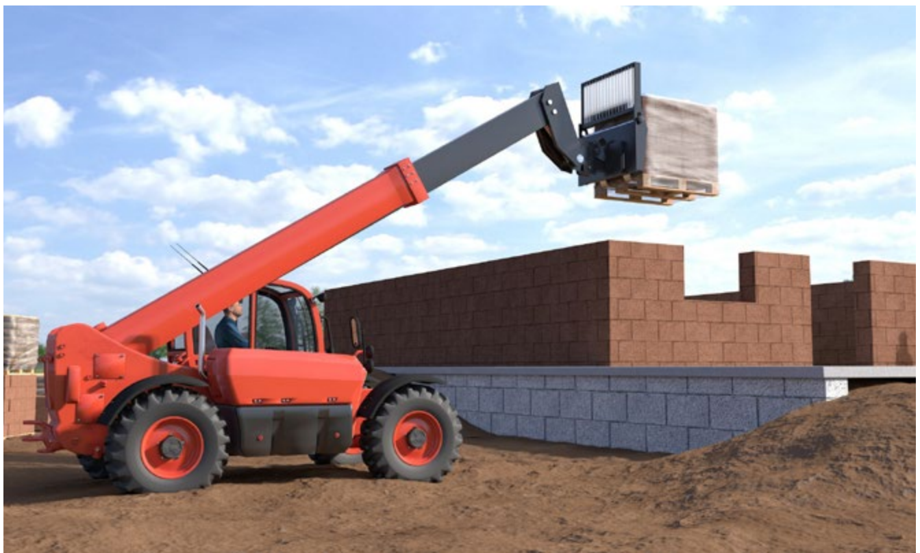
Abb. 72 Teleskopradlader beim Transport von Material
