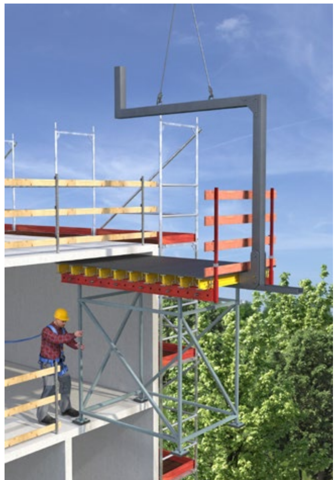
Abb. 120 Schaltisch mit integriertem Seitenschutz
