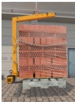
Abb. 90 Krangabel mit Sicherungskette
